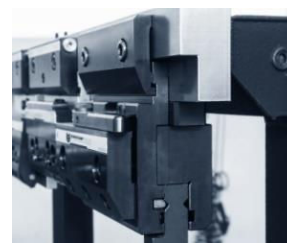
4393 Bride + intermédiaire à insertion par la façade M WDP Z1 Intermédiaire axe à 7 mm, pour poinçons type WILA 807 €
