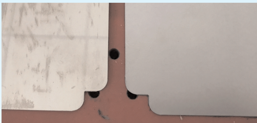
photos: tôles traitées avec 2 medium discs en amont (ébavurage) et deux disques OF-250 en aval (orbital)
